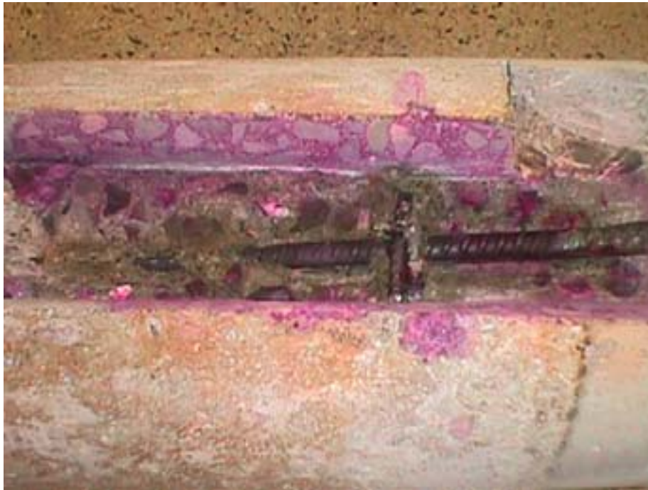
Figura 1.8. Aspecto que presenta una muestra después de adicionarle solución alcohólica de fenolftaleína al 1%.
