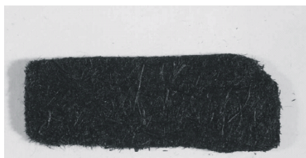
Figura 2.9. Fotografía de fibras de carbón activo obtenidas a partir de la pirólisis de residuos textiles (Williams y Reed, 2003).
